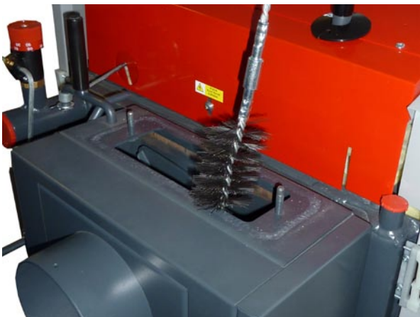
Vorführung der Reinigung des Rauchkanals mit Drahtbürste.
